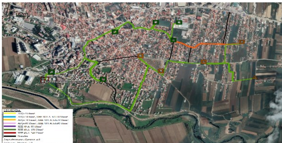
Figura 17. Topologjia e propozuar e Unazës III
