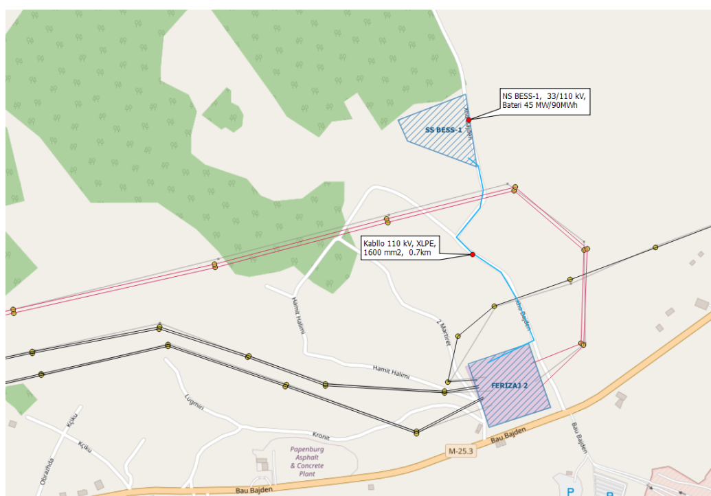
Figura 5-17. Shtrirja gjeografike e projektit BESS 1 (Bateria Akumuluese 45 MW/90MWh)
