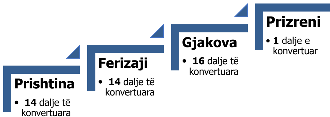
Figura 1. Konvertimi i daljeve nga 10 [kV] në 20 [kV].
