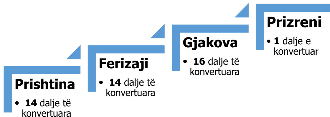
Figura 10. Konvertimi i daljeve nga 10 kV në 20 kV
