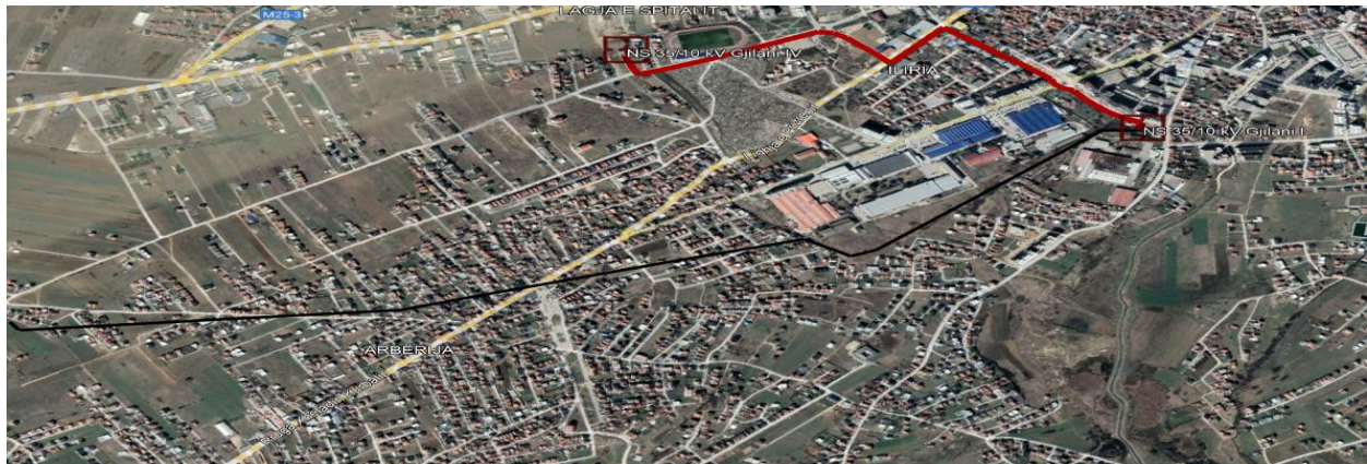
Figura 9. Topologjia e linjës 35 [kV] Gjilani I - Gjilani IV në Google Earth.
